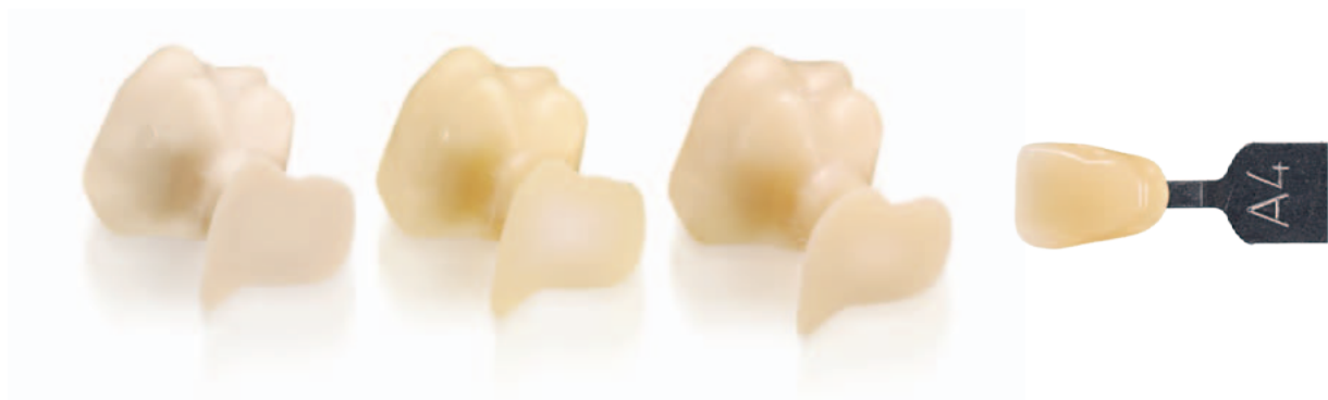
Abb. 24: Vergleich der Farbpassung eines mit A4 eingefärbten dreigliedrigen Brückengerüsts, das am Zwischenglied durchtrennt wurde. Von links nach rechts: Crystal™ Zirkonoxid HS, Färbelösung A4, Prettau; VITA™ In-Ceram® YZ, VITA™ In-Ceram® YZ, Färbelösung LL5; Lava™ Plus hoch transluzentes Zirkonoxid, Lava™ Plus hoch transluzente Zirkonoxid-Färbelösung A4; VITA Classical Farbring.
