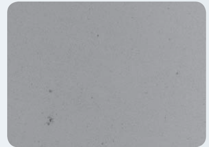
Abb. 36: Lava™ Plus Zirkonoxid-Oberfläche, mit EVE 2-Schritt-Zirkonoxid Poliersystem poliert (500-fache Vergrößerung).
