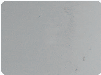
Abb. 45: REM-Bild einer polierten Lava™ Zirkonoxid-Oberfläche (500-fache Vergrößerung).
