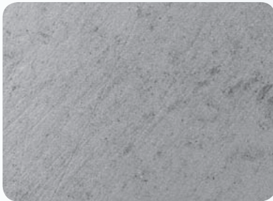
Abb. 34: Lava™ Plus Zirkonoxid-Oberfläche nach dem Brand (500-fache Vergrößerung).
