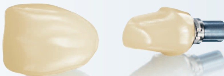
Abb. 24: Krone aus Lava™ Plus hoch transparentem Zirkonoxid, verblendet mit Creation ZI-F Willi Geller, Lava Plus hoch transparenter Zirkonoxidaufbau für zweiteiliges Abutment, eingefärbt mit Effektfarbe Fluoreszenz und Lava™ Plus Färbelösung A2; der Zirkonoxidaufbau wurde mit RelyX™ Unicem 2 auf der Metallbasis befestigt.
